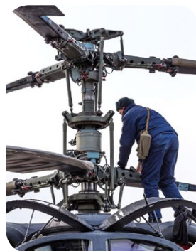
Obr. 16 koaxiálne usporiadanie rotorových hriadeľov vrtuľníka Ka-52M
