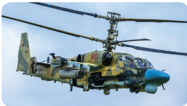
Obr. 16 koaxiálne usporiadanie rotorových hriadeľov vrtuľníka Ka-52M
