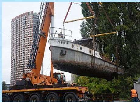
2023: Preloženie lode z traileru na kovové podložky
