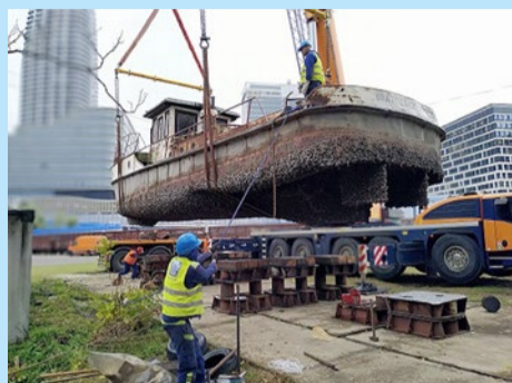
2023: Manipulačné práce s presným uložením lode na kovové podložky
