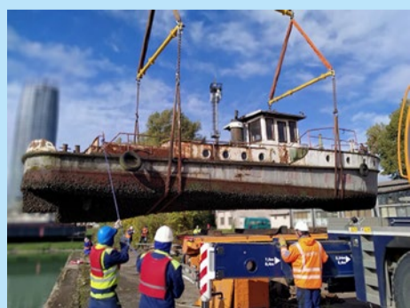
2023: Manipulačné práce s remorkérom ZVOLEN visiacim na autožeriave
