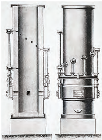
Kuplová pec Greinerovej konštrukcie vyvinutá v Chyžníanskej Vode, patentovaná roku 1885, zavedená prvýkrát v Chyžníanskej Vode
