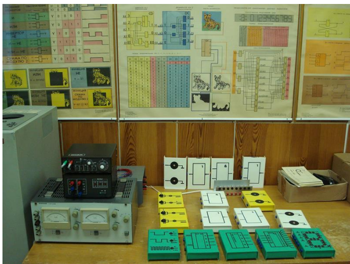
Obr. 5 Stavebnica logických obvodov s napájacími zdrojmi
