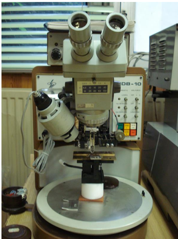
Obr. 4 Prístroj pre poloautomatické prepájanie vnútorných kontaktov čipu s kontaktmi zapuzdreného IO
