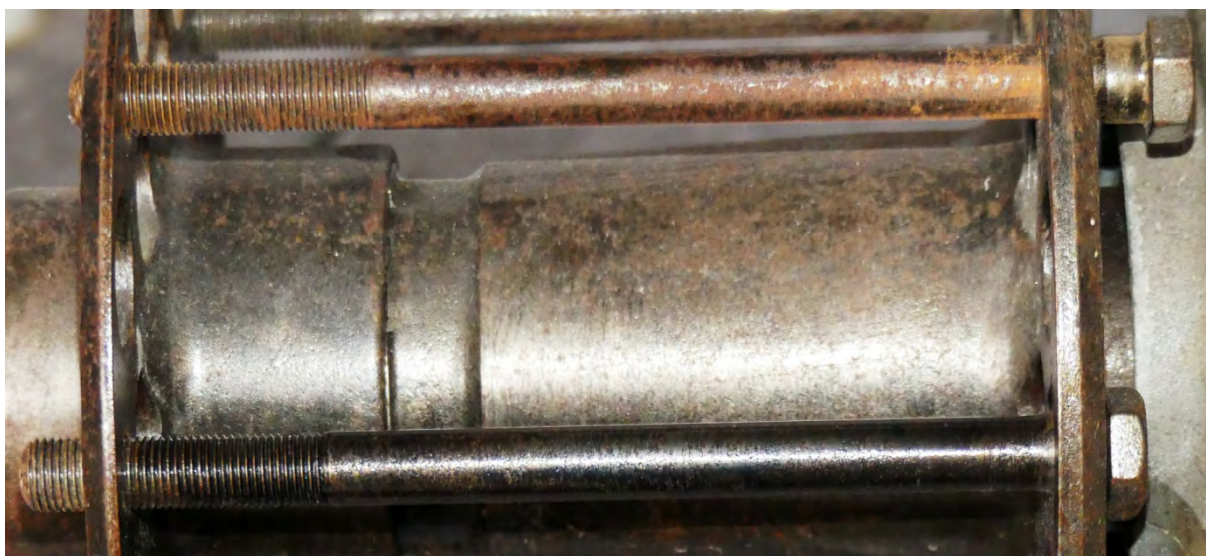
Obr. 175 - Porovnanie stavu dvoch skrutiek, dolná – ošetroená (stav po 710 dňoch), horná - neošetroená
