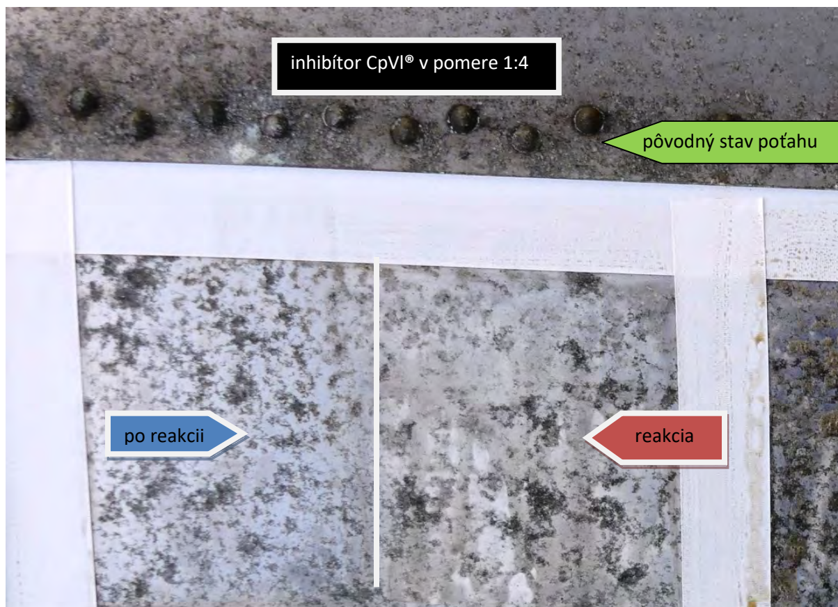
Obr. 93 - Reakcia po nanesení inhibítora v pomere 1:4
