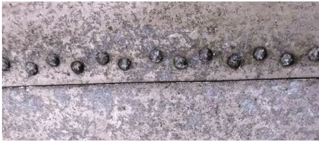
Obr. 30 - Poťah napadnutý koróziou
