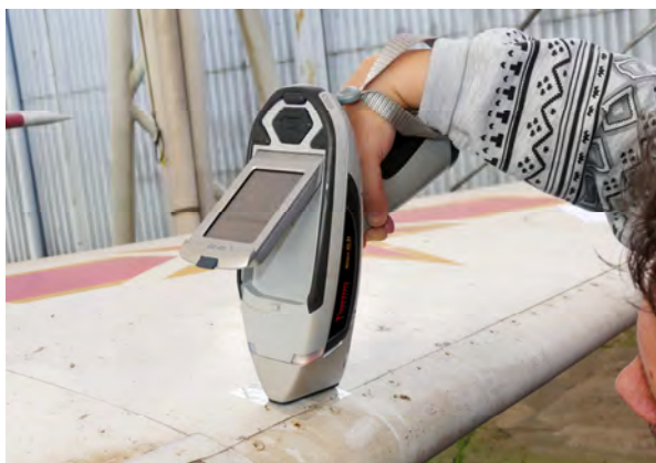
Obr. 76 a Obr. 77 - Analýza duralového potahu krídla a trupu
