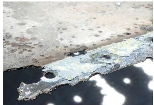
Obr. 33 - Detail odtokovej hrany
