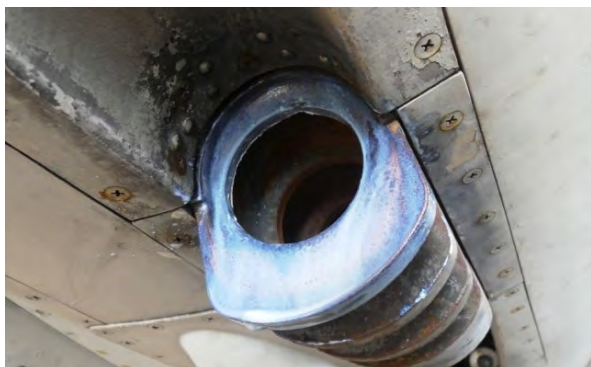
Obr. 181 a Obr. 182 - Aplikovanie inhibítora WÜRTH na čelnú a zadnú stranu dosky ejektora
