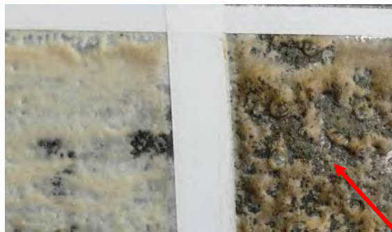
Obr. 254 - Reakcia na očistený a neočistený povrch
