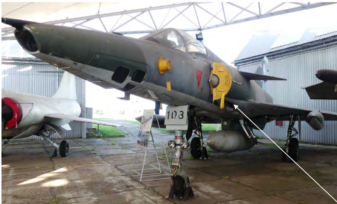
Obr. 176 - Testovaná plocha - ejektor hlavne kanóna
