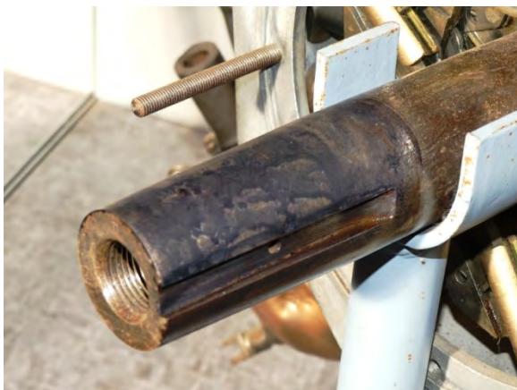
Obr. 62 - Po zaschnutí vykazuje matný povrch
