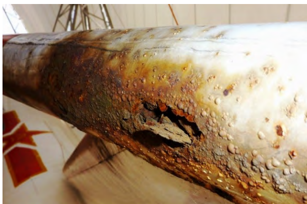
Obr. 22 - Protifláterové závažie, devastačný stav
