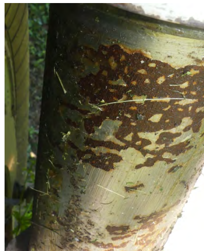
Obr. 26 a Obr. 27 - Poškodenie povrchu a strata chrómovanej vrstvy
