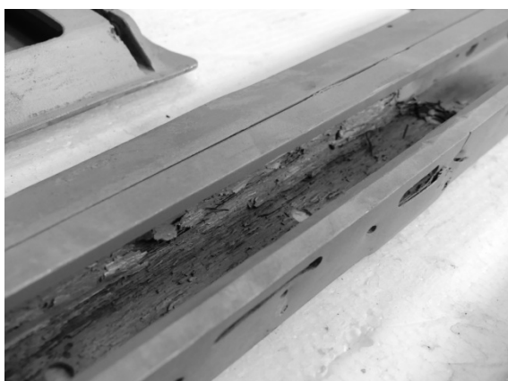
Obr. 39 a Obr. 40 - Koróziou poškodená pojazdová lišta dverí
