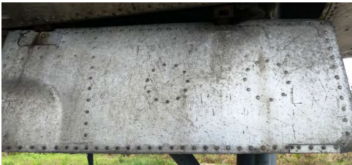
Obr. 101 - Pôvodný poťah na kryte predného podvozku lietadla Il-14
