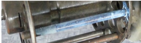
Obr. 169 - Nanesenie inhibítora na povrch skrutky
