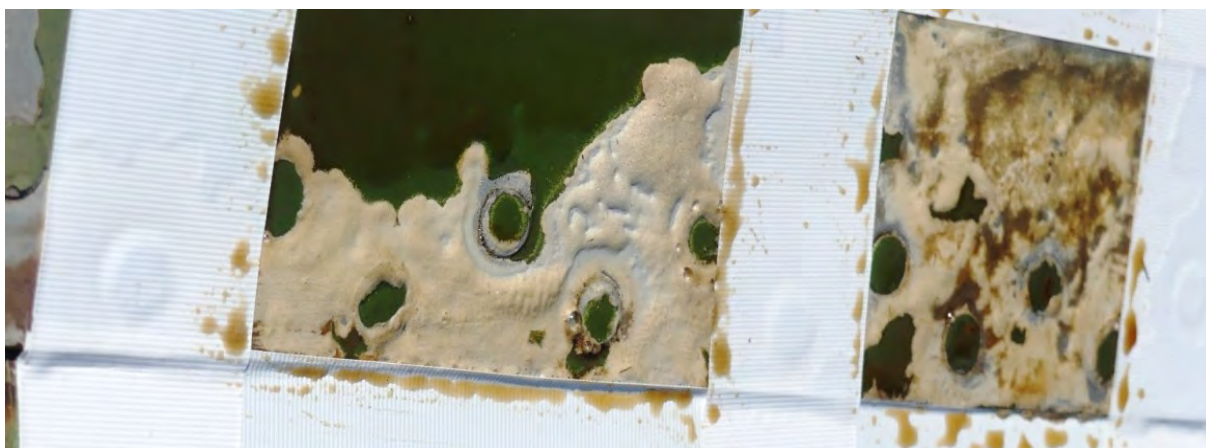
Obr. 126 - Reakcia inhibítora na oboch plochách
