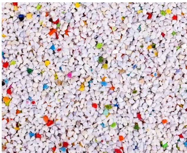
Obr. 47 - Abrazívum FISHER JET plast typ III
