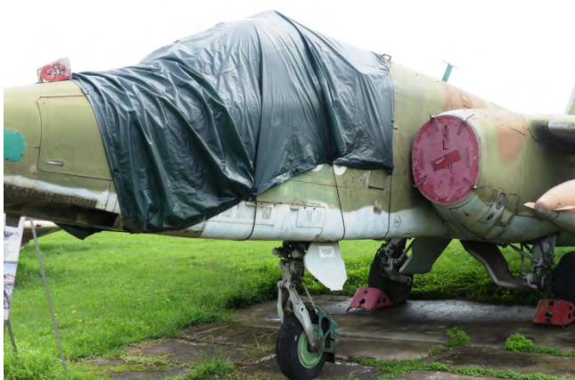
Obr. 7 - Ochranný povlak ako súčasť preventívnej ochrany
