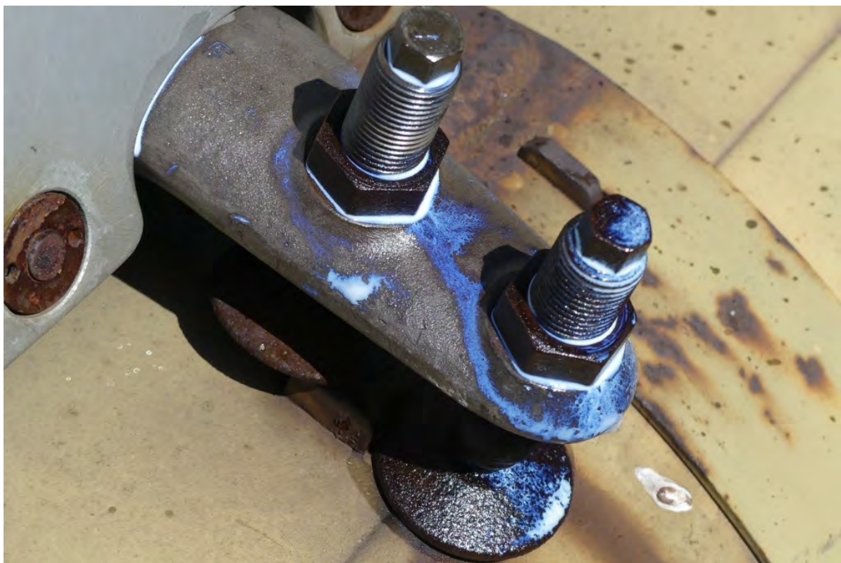
Obr. 120 - Aplikovanie inhibítora WÜRTH - pomalé zasychanie
