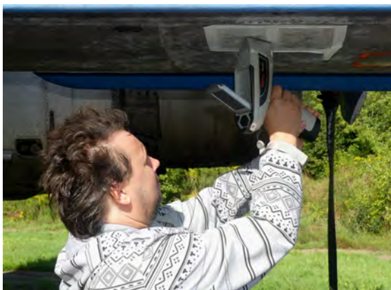
Obr. 76 a Obr. 77 - Analýza duralového potahu krídla a trupu
