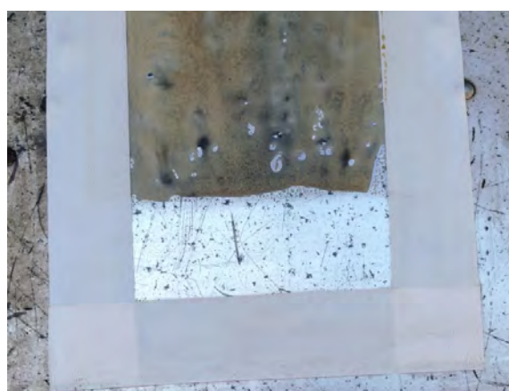
Obr. 103 - Rozdielne reakcie inhibítorov WÜRTH a VpCI®-427
