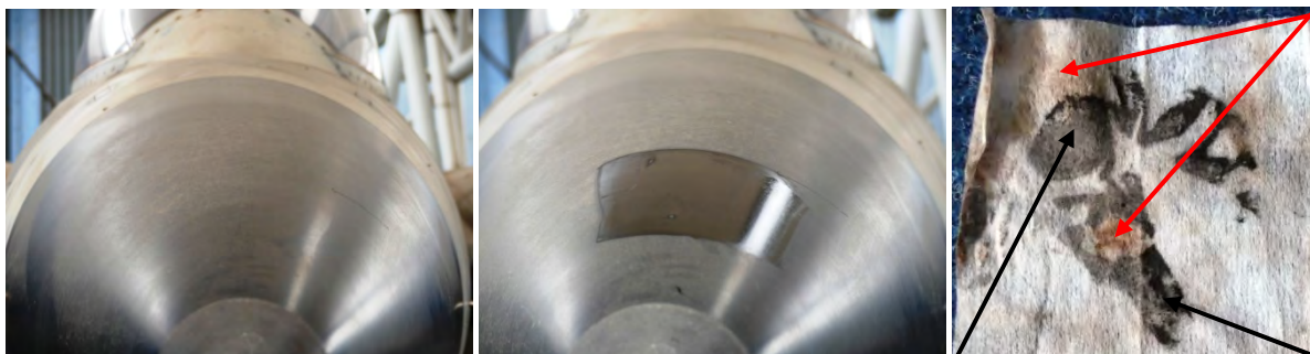
Obr. 19 - Predná časť trupu po umytí Obr. 20 - Po dokonalejšom očistení Obr. 21 - Oter farby a prachu
