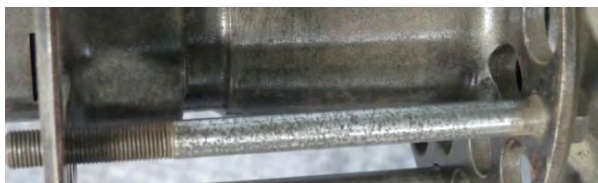
Obr. 168 - Finálne očistenie skrutky na kov
