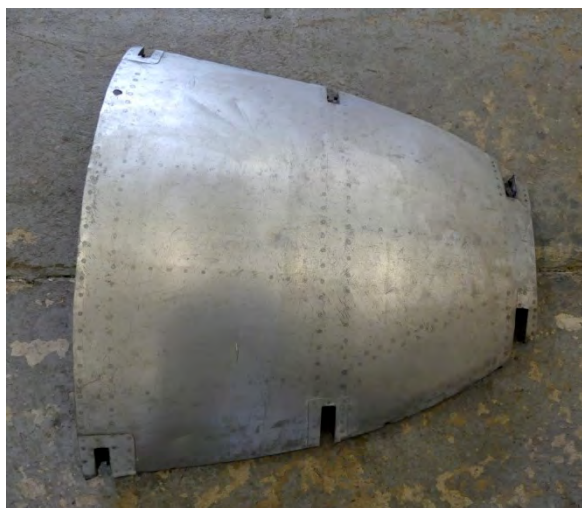
Obr. 73 - Kryt po očistení od mechanických nečistôt
