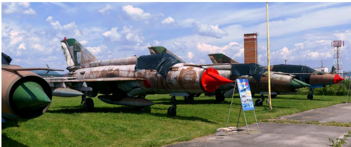
Obr. 1 - Letecká technika na voľnom priestranstve – opotrebovaný, poškodený povrchový náter
