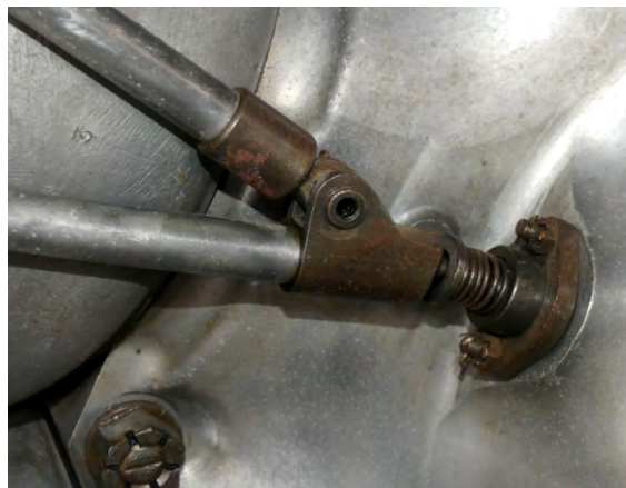
Obr. 71 - Korózia na spojovacom telese
