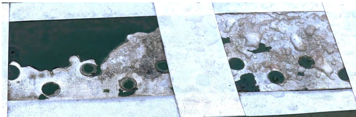
Obr. 127 - Stav 0, po ošetroení lakom je viditeľná vode odpudivá reakcia
