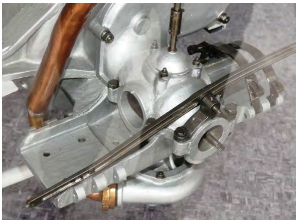
Obr. 70 - Bezkorozívny stav motora v kóji
