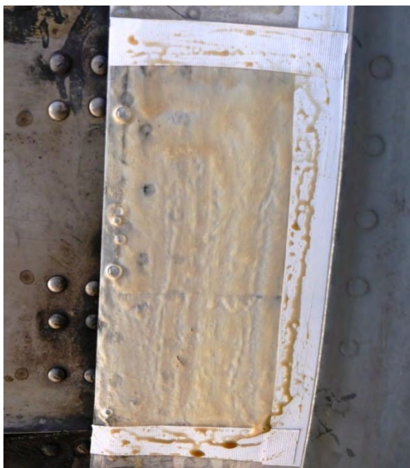
Obr. 198 - Reakcia inhibítora v neriedenom stave
