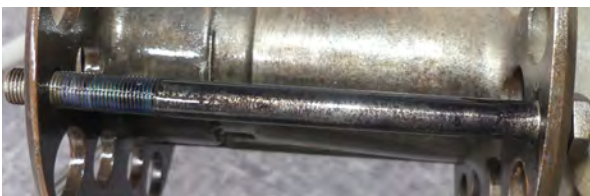
Obr. 171 - Finálne ošetrenie ochranným lakom
