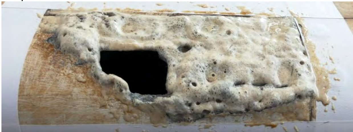
Obr. 147 - Reakcia po použití inhibítora na poškodenom poťahu
