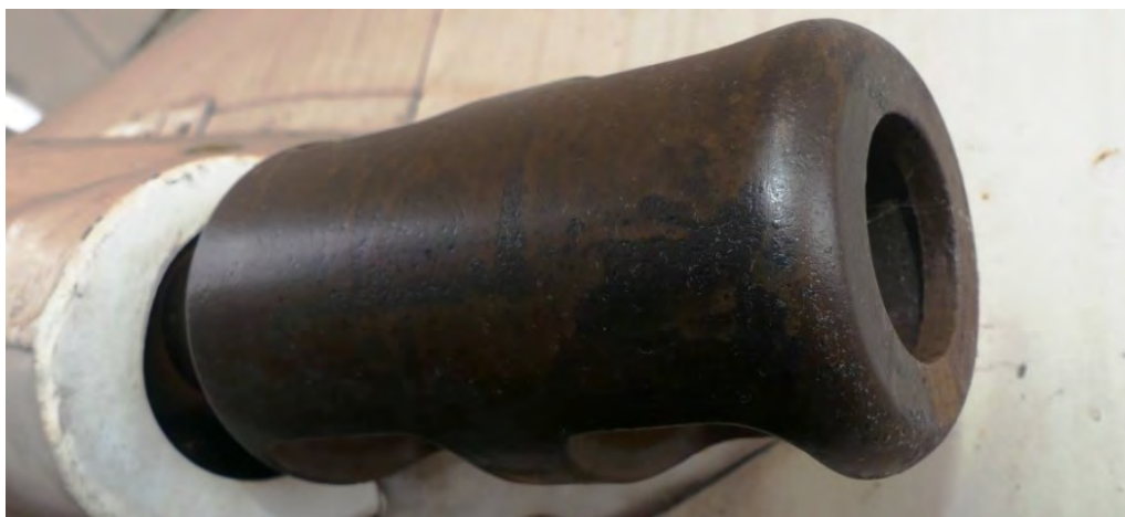
Obr. 142 - Aplikovaná ochranná vrstva bezfarebného laku
