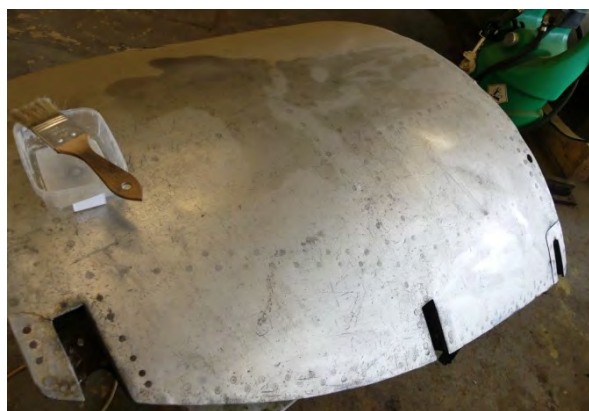
Obr. 240 - Odmastenie technickým benzínom
