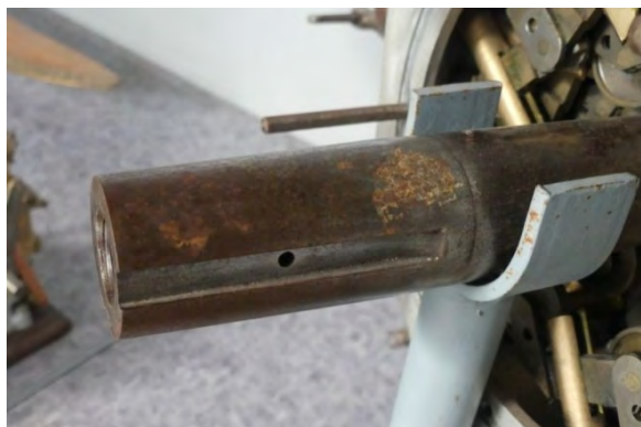
Obr. 154 a Obr. 155 - Korózia na hriadeli motora
