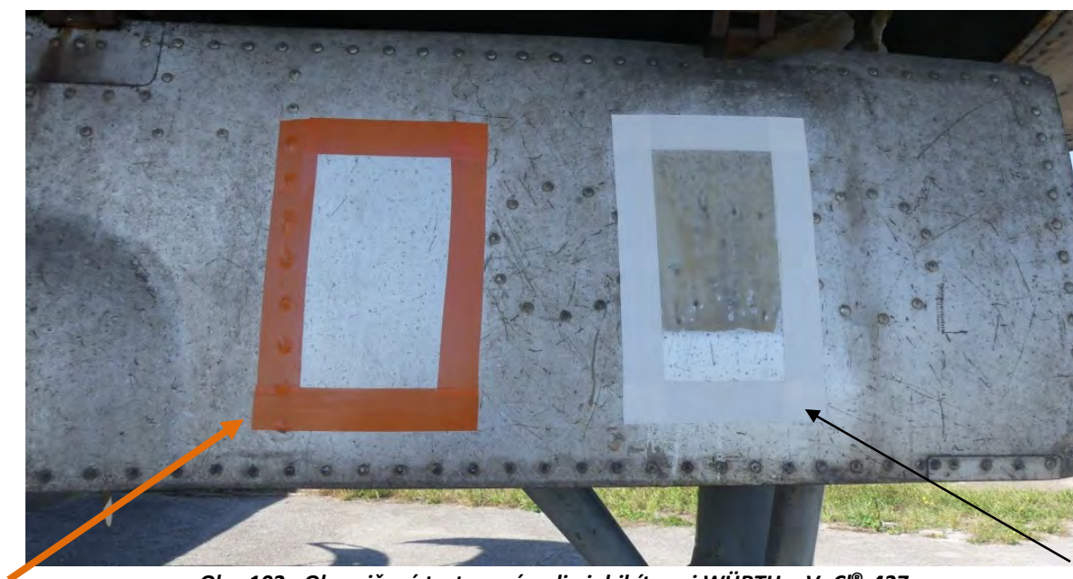
Obr. 102 - Ohraničené testované polia inhibítormi WÜRTH a VpCI®-427
