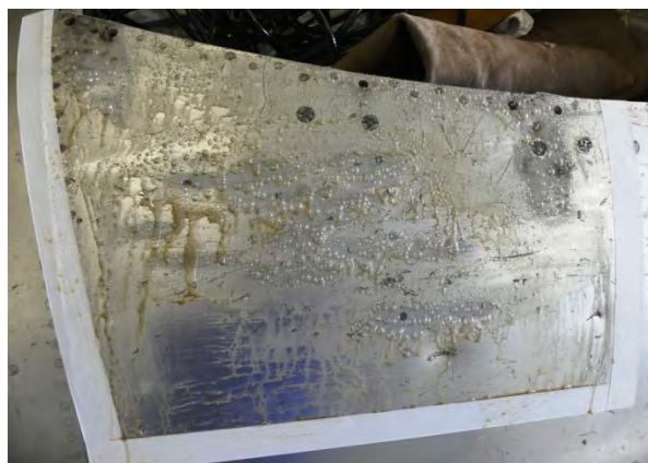
Obr. 233 - Nanosenie inhibítora a jeho reakcia
