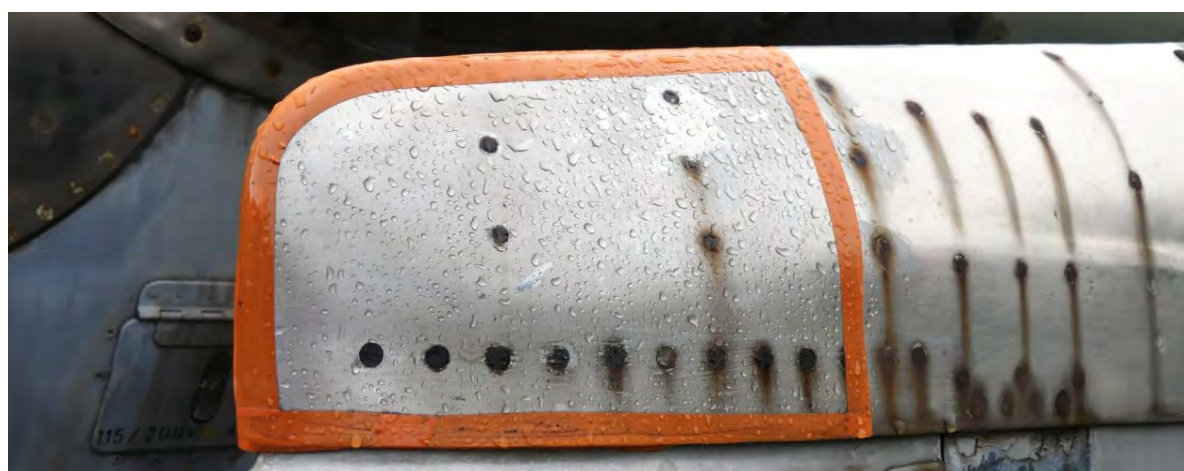
Obr. 114 - Reakcia na vodné zrážky v podobe vode odpudivej vrstvy
