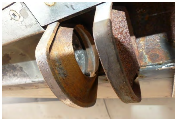
Obr. 178 - Priebeh korózie po celej ploche
