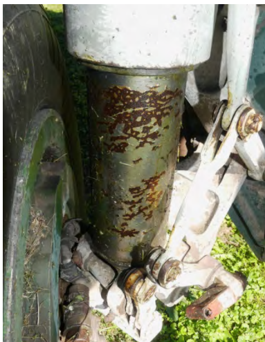
Obr. 26 a Obr. 27 - Poškodenie povrchu a strata chrómovanej vrstvy
