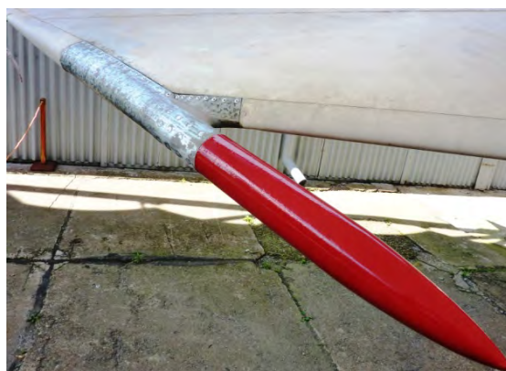
Obr. 23 - Stav po oprave a montáži
