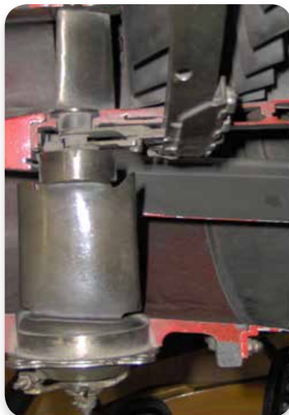
Obr. 6 Ovládanie vstupných usmerňovacích lopatiek kompresora 17
