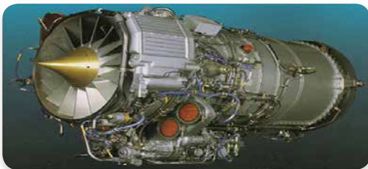
Obr.3 Celkový pohľad na motor DV-2
