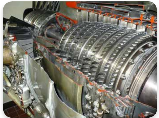
Obr. 5 Rez vysokotlakového kompresora motora AI-25TL 16
