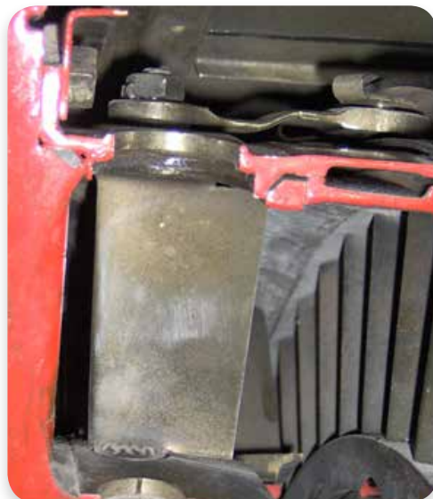
Obr. 7 Detail nastaviteľnej lopatky vstupného usmerňovacieho ústrojenstva vysokotlakového kompresora motora AI-25TL 18
