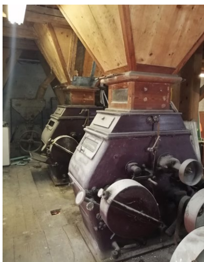
Obr. č. 9: Dvojité valcové stolice v mlynici Rusiňákovho mlyna v Spišskom Štiavniku. Zdroj: D. Patera, osobný archív.
