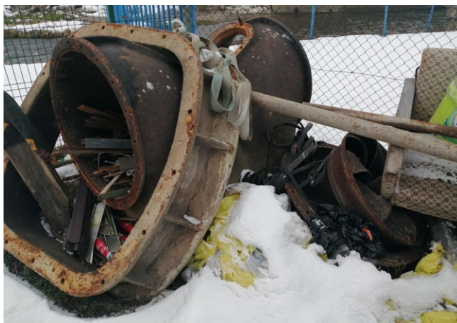
Obr. č. 7: Dvojité turbína Francis zo zaniknutého mlyna v Smižanoch, ktorá fungovala donedávna v MVE Flúder v Spišskej Novej Vsi. Zdroj: D. Patera, osobný archív.
