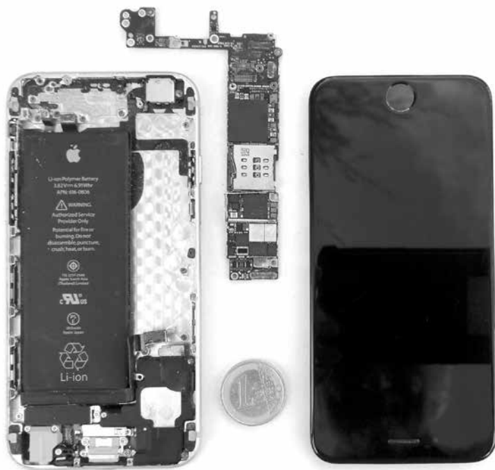
Obr.3: Rozobratý smartfón iPhone 6. V strede je matičná doska s čipom A8 – mozgom prístroja.
