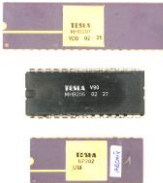
Obrázok 7. PZIO HP 202, HP 216, HP 226 a HP 227, ktoré boli súčasťou osadenej DPS polovodičovej operačnej pamäti DRAM+PROM
